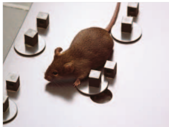
Mit dem „modified hole board“ lässt sich Verhalten wie Ängstlichkeit messen und vergleichen (Aufnahme von Bernd Müller).
