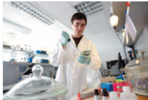
Vorbereitung eines Next-Generation Sequenzierlaufs : Sven Stengel bei der Bestückung eines Glaträgers mit DNA-beladenen Beads für die hochparallele Sequenzierung von bis zu 700 Millionen unterschiedlichen DNA-Spezies zur gleichen Zeit.
