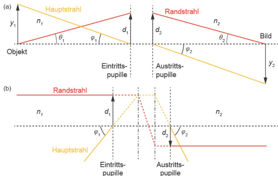
Der Ausgangspunkt ist die Formulierung der Lagrange-Invariante für die voneinander (linear) unabhängigen Randstrahlen (rot) und Hauptstrahlen (gelb) in Abbildung 29.1.1. Die Lagrange-Invariante für diesen allgemeinen Fall lautet
